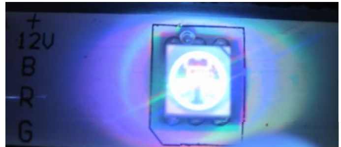
Bild: LED-Lichtband mit additiver Farbmischung
